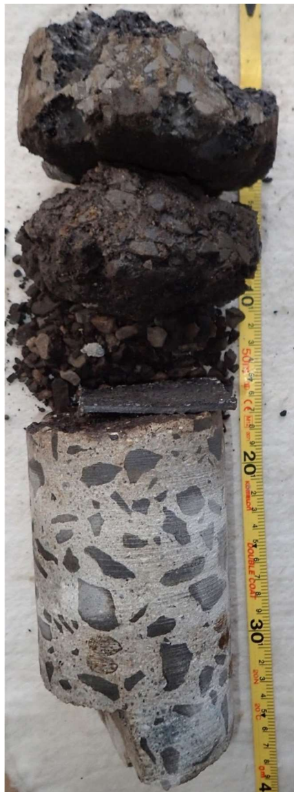
Obrázek č. 40 – sonda do vozovky – vývrt
